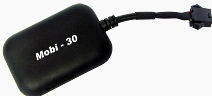
O **Mobi - 30** através da integração da tecnologia GPS com a tecnologia de transmissão de dados GPRS possibilita utilizar os mais avançados recursos para rastreamento e monitoramento de veículos .
